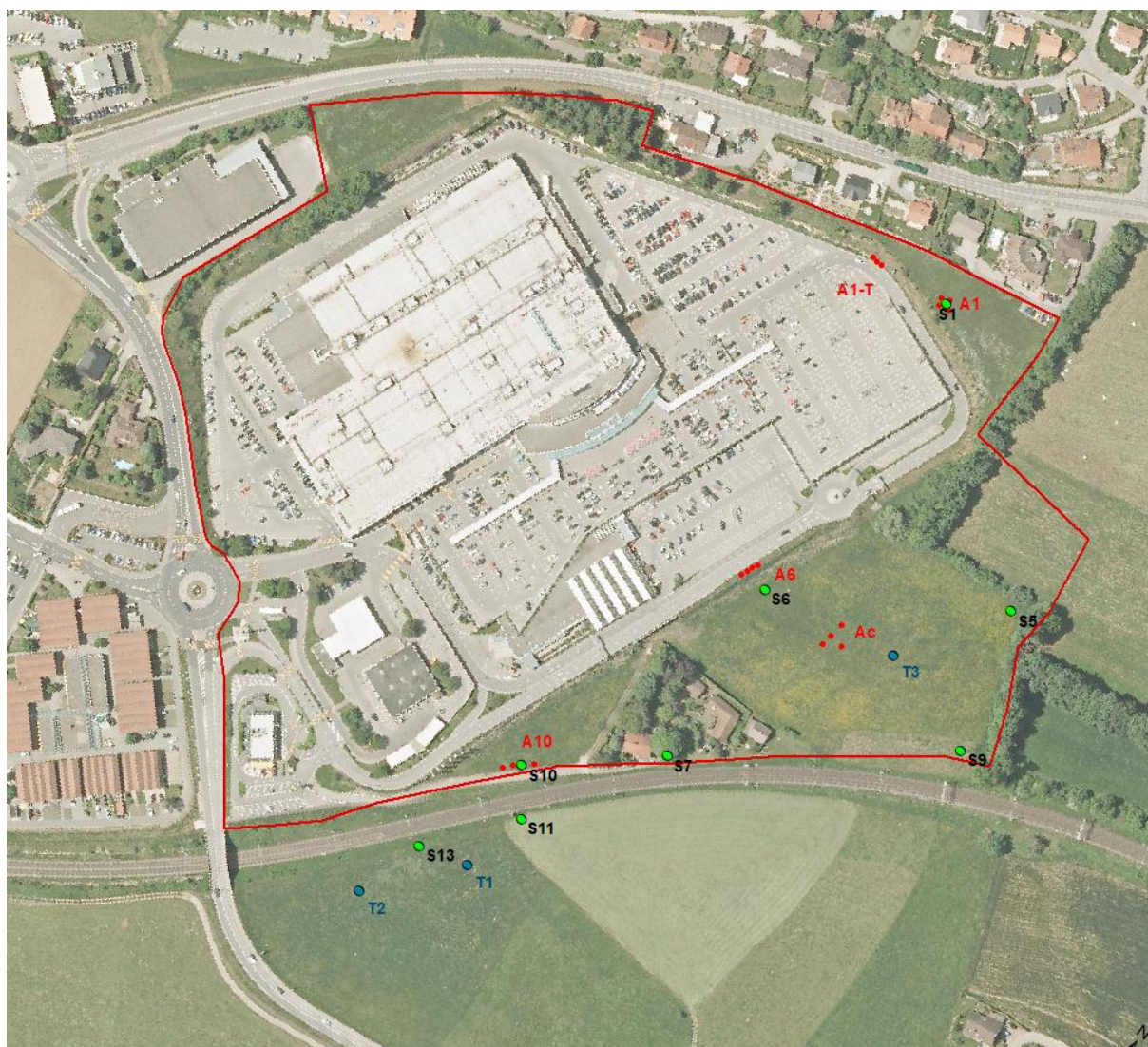
Figure 34 : Situation des sondages (forage en vert / tarière en bleu) et des prélèvements (en rouge)
